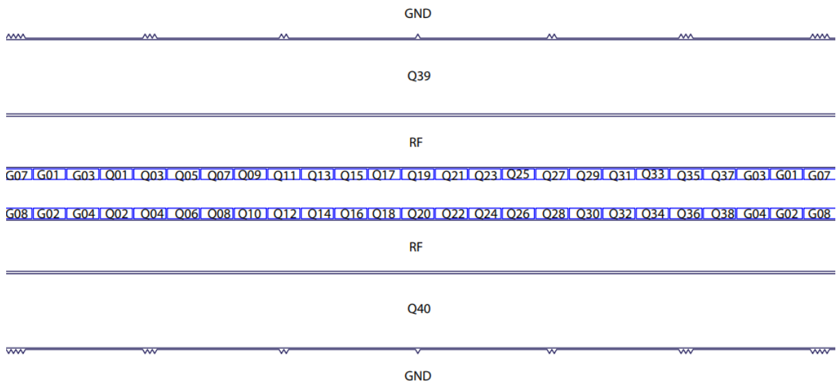
Rysunek 1.3: Schemat rozmieszczenia elektrod w centralnej części pułapki HOA. Elektrody rozmieszczone są co 70 \mu\text{m} , zaś szerokość szczeliny pomiędzy elektrodami, gdzie łąpane są jony, wynosi 60 \mu\text{m} [23].
