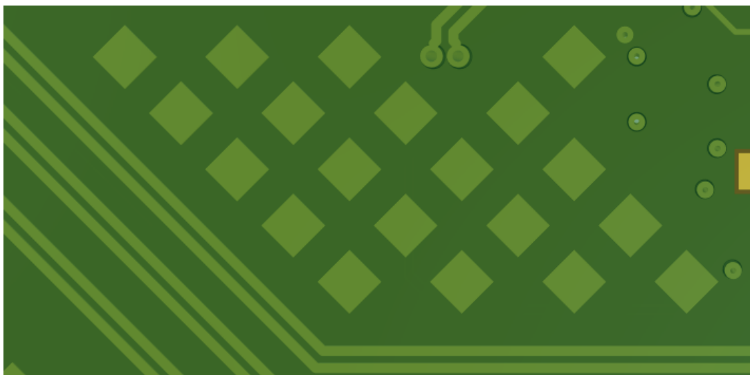
Rysunek 7.16: Przykład zaimplementowanego balansu miedzi.
